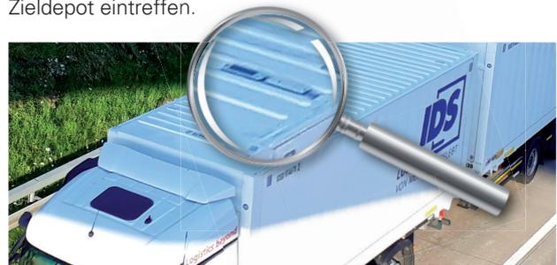
GPS-Solarmodul zur Ortung der Wechselbrücke
